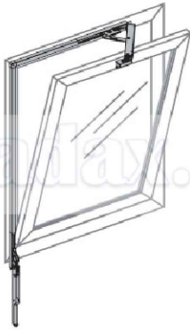
Schemat otwierania okna z poziomu posadzki-otwierzcz
